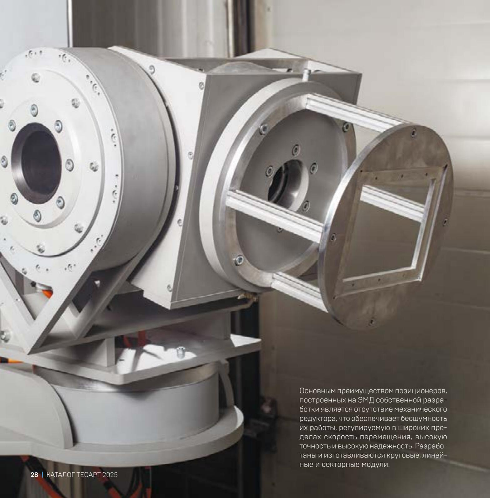
Основным преимуществом позиционеров, построенных на ЭМД собственной разработки является отсутствие механического редуктора, что обеспечивает бесшумность их работы, регулируемую в широких пределах скорость перемещения, высокую точность и высокую надежность. Разработаны и изготавливаются круговые, линейные и секторные модули.
